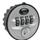
④ **Poignée serrure à code 4 molettes réinitialisable** : alternative intéressante pour des utilisateurs temporaires. Une clé passe permet de déverrouiller la serrure en cas d'oubli du code.
