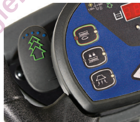
Une palette permet d'activer et de désactiver le système Ecoflex
