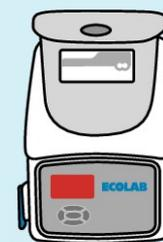
4. Remplir le compartiment produit lorsque l'écran du contrôleur l'indique (l'écran devient rouge et une alarme sonore retentit). L'alarme est désactivée soit à l'aide du bouton situé sous l'écran, soit par l'ouverture du couvercle du compartiment.
